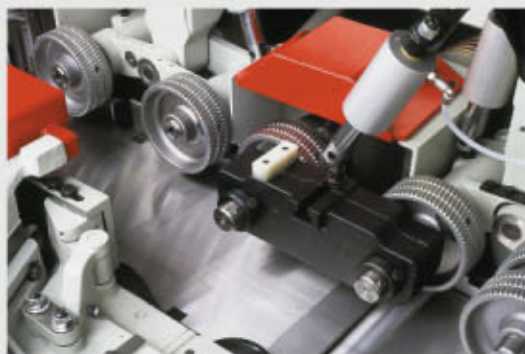
右立軸前の送材を補助する 短尺送り装置
