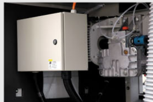
インバーター式送り速度制御 (無段変速)
