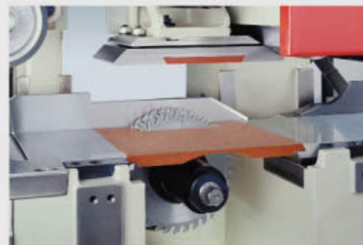
第2下軸によるノコ割り加工
