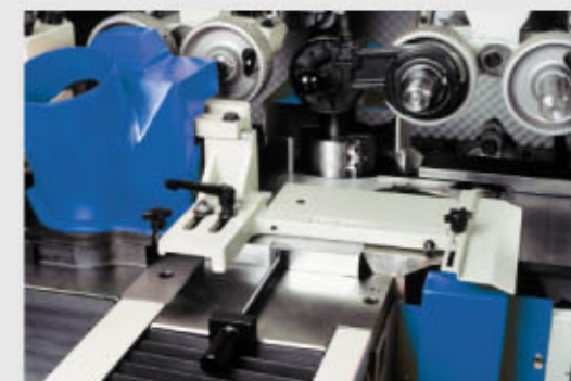
立軸前の定盤は、親子定盤となっており、 刃物の外径に合わせて自由に調節できます。
