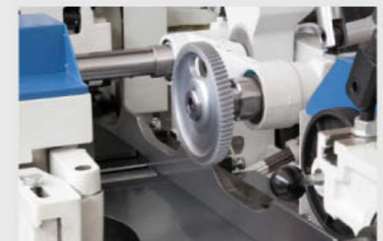
左軸前の送りローラーシャフトは、加工する幅に 応じて、35mmまで出し入れできます。
