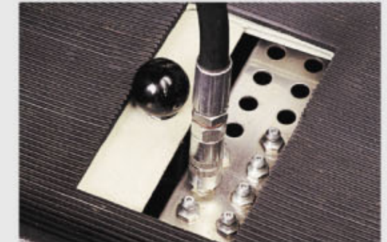
メンテナンスも実にシンプル！ グリスポイント前面集中配置
