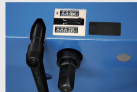
上軸・左軸 デジセットによる、 製品幅・製品厚のカンタン調節！
