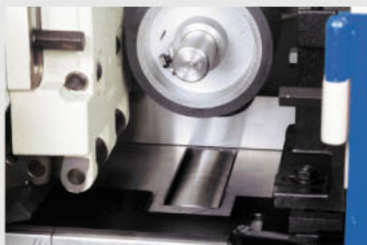
定盤内駆動ローラーによる、確実な送材
