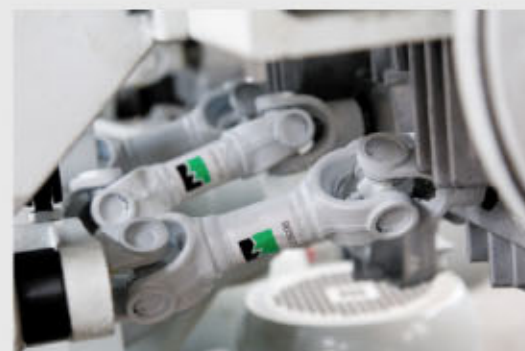
ユニバーサルジョイント方式による 安定した送材
